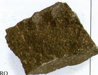
COLOR INTERMEDIO La andesita, una roca intermedia, con un contenido total en sílice del 55-65%.
