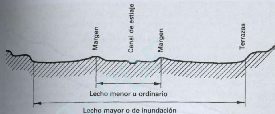
Figura 11.9. Corte esquemático de un lecho fluvial.
