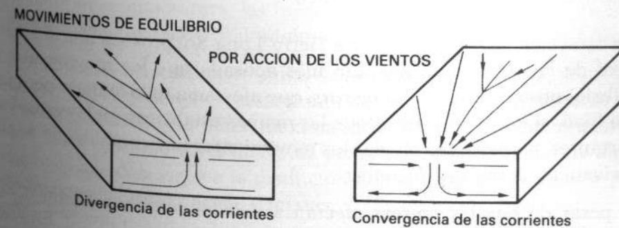
Figura 4.5. Los movimientos de equilibrio de las aguas marinas tienen diversas causas. La figura muestra la acción de los vientos, que dan lugar a convergencias o divergencias de las corrientes superficiales.
